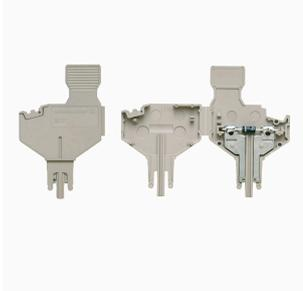
插头组件用于将电气组件安装在可拆式接线端子。电子组件完成焊接之后，可以将插头安装到可拆式接线端子的断开区域，从而将可拆式接线端子变成配有内置电子组件的模块化接线端子。
