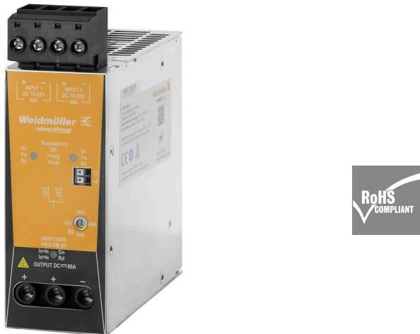
在众多的自动化应用中，要求电源系统即使在电源单元发生故障的情况下仍能可靠地运行。通过我们最佳匹配的补充模块，可以创建一个持久耐用的供电概念。魏德米勒的二极管和冗余模块将两个电源连接在一起，充当一个设备的备用，以应对故障的情况。冗余模块的使用可以大大提升系统可用性，这是至关重要的。每个冗余支路都能够提供完整的输出负载。在电源故障的情况下，24V 控制电压仍然保持稳定。我们冗余模块中使用 MOSFETs 可以实现最佳效率。
