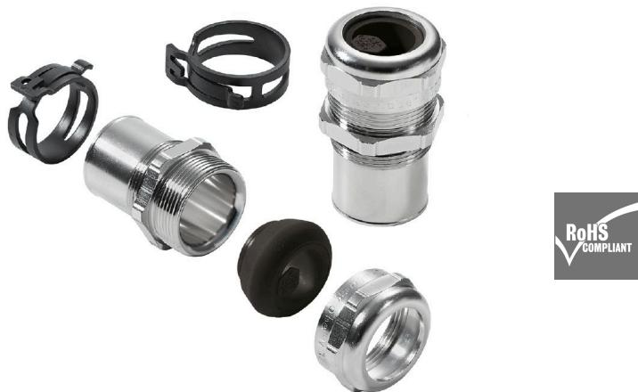
随着电子组件的灵敏度不断提高，电磁干扰频率不断提高，电缆接头需要在系统的屏蔽概念中发挥重要作用。这类EMC电缆接头采用360°筛查接线点，可屏蔽干扰频率。手指锁定密封件可提供出色的电缆保持和张力释放效果，其旁边的电缆接头符合EN 62444的机械要求。专利设计让组装变得轻松快捷。
