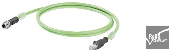
应用于EtherNet/IP 应用的预装配 IE 电缆， 带符合 IEC 61076-2-109 的 M12 X型 6A 类接插件和适合 10 Gbit/s 应用的 RJ 45 接插件
