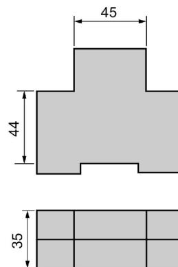
图纸中列出了适用于 RCBO 剪切的 RCBO 的尺寸（根据 DIN 43880）。每个符合该尺寸的 RCBO 均适用。
