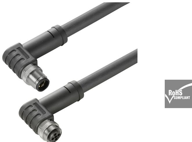
您的外围设备应配备更大的电源。借助我们新的 M12 接插件，超过 250 V 和 2 A 的电压不会出现任何问题。紧凑型 A-、K-、L-、S- 和 T- 编码 M12 接插件用于传输最高 630 V 交流电或 60 V 直流电的电压以及 12 A 的电流。
