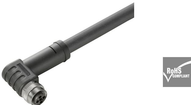
您的外围设备应配备更大的电源。借助我们新的 M12 接插件，超过 250 V 和 2 A 的电压不会出现任何问题。紧凑型 A-、K-、L-、S- 和 T-编码 M12 接插件用于传输最高 630 V 交流电或 60 V 直流电的电压以及 12 A 的电流。
