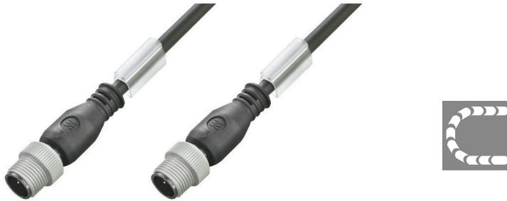
传感器/执行器电缆用于传感器和执行器布线，可在多个应用中实现数据或电力传输。上述模压电缆与接插件配合使用，提供有效、经验证的联接。电缆可用于包括湿度、粉尘、高温、低温、冲击或震动的各种环境条件。我们的研发团队对上述问题进行了集中探索，设计出一系列特制M8和M12传感器/执行器电缆，总有一款适合您。M8和M12传感器-执行器电缆的标准配置包括黄铜镀镍螺母。但如果产品的工作环境极为严酷，您也可以选择配备不锈钢螺母版本的产品。在镀镍M8和M12螺母可能锈蚀且受机械条件限制不能使用塑料螺母的情况下，应当采用上述解决方案。没能找到您需要的产品？或许您能对所需产品进行具体描述？请与我们联系！
