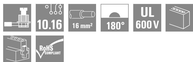
180° 插孔式插头，间距 10.16，用于 IT 电网。满足 UL1059 600 V 等级 C 标准。与带有引线接触点的插针式插座 SU 10.16 IT 组合使用。
