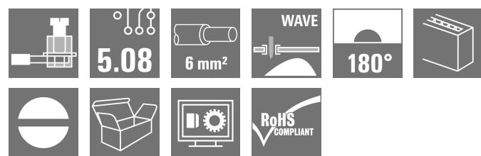
该印刷线路板接线端子可为 32 A、6 mm<sup>2</sup> 导线截面积提供联接，采用久经验证的压线框联接，间距为 5.00 和 5.08 mm。90° 导线出线方向。
