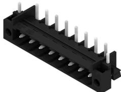
耐高温, 直型开口款插座。用纸盒或卷带包装。卷装插座采用 1.5mm 焊针, 适合自动装配。3.2mm 长的焊针适合采用回流焊和波峰焊进行处理。针式插座上有空间进行标记和编码。HC = 大电流
