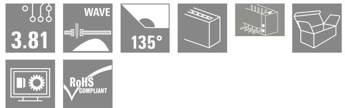
插座 SC 的进线方向为 135° - 135°是指为插接方向和焊针之间的夹角，表示进线方向与印刷线路板成倾斜的 45°角。
