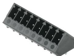
耐高温插座 SC-SMT，进线方向为 135°：135°是指为插接方向和焊针之间的夹角，表示进线方向与印刷线路板成倾斜的 45° 角。
