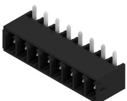
耐高温插座 SC-SMT, 进线方向为 270° : - 270°是指为插接方向和焊针之间的夹角, 表示插接方向与印刷线路板平行, 从插头上方插入。
