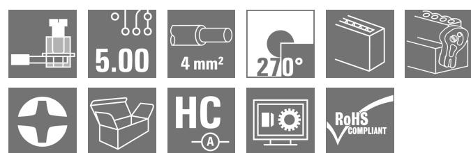
立式 (90° 或 270°) 出线压线框接线插头。插头上有空间供标记和编码使用。通过法兰或释放杆锁紧。提供十/一字头螺钉和导线误插保护，与打开的压线框配套交付。HC = 大电流
