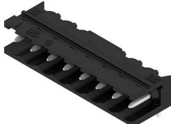
耐高温式插座 (90°) 用纸盒或卷带包装。卷装插座采用 1.5mm 焊针, 适合自动装配。3.2mm 长的焊针适合采用回流焊和波峰焊进行处理。针式插座上有空间进行标记和编码。HC = 大电流
