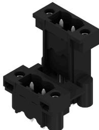
耐高温双层闭合插座，横向偏置，可选配焊接法兰。1.5 毫米焊针适合回流焊。3.2 毫米焊针适合回流焊和波峰焊。提供标记和编码空间。
