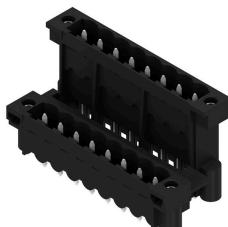
耐高温双层插座, 对插面错层分布, 带法兰或焊接法兰。1.5 毫米焊针适合回流焊。3.2 毫米焊针适合回流焊和波峰焊。提供标记和编码空间。
