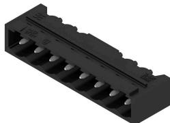
耐高温插座, 采用纸盒包装或卷带包装。卷装插座采用 1.5mm 焊针, 适合自动装配。3.2mm 长的焊针适合采用回流焊和波峰焊进行处理。针式插座上有空间进行标记和编码。HC = 大电流
