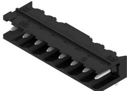
耐高温式插座 (90°) 用纸盒或卷带包装。卷装插座采用 1.5mm 焊针，适合自动装配。3.2mm 长的焊针适合采用回流焊和波峰焊进行处理。针式插座上有空间进行标记和编码。HC = 大电流
