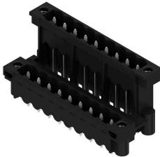
耐高温双层闭合插座，横向偏置，可选配焊接法兰。1.5 毫米焊针适合回流焊。3.2 毫米焊针适合回流焊和波峰焊。提供标记和编码空间。
