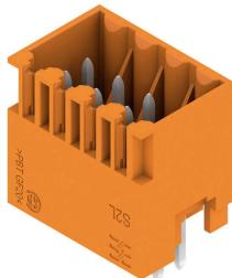
直型双排插座, 有闭口或法兰版本 (如有要求可提供一侧开放的版本)。插座的插针长为3.5 mm, 适用于波峰焊, 盒装。可以螺钉固定于印刷电路板 (PCB)。组件上有空间供标记和编码使用。
