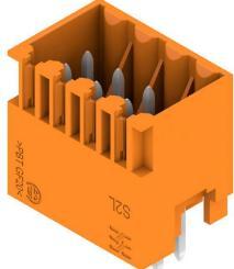
直型双排插座, 有闭口或法兰版本 (如有要求可提供一侧开放的版本)。插座的插针长为 3.5 mm, 适用于波峰焊, 盒装。可以螺钉固定于印刷电路板 (PCB)。组件上有空间供标记和编码使用。
