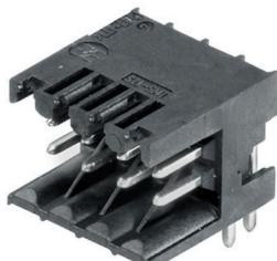
耐高温，直针双层插座，适用于所有常规焊接。为自动装配进行了优化设计。提供盒装或卷带式包装。焊针长度为3.2mm，适合回流焊和波峰焊。该插座提供标记和编码空间。(按照要求可提供卷带式包装)
