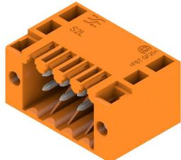
双层弯针插座有标准闭口型或螺钉法兰型（根据要求可提供侧面开口的插座）。焊针长度为 3.5 毫米，适合于波峰焊，提供盒装。可以螺钉连接在线路板上。该插座提供标记和编码空间。
