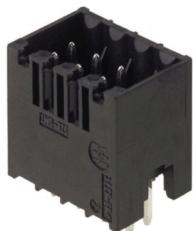
耐高温双层插座，适应所有常见焊接方法。经优化，完美满足自动装配的要求。用纸盒或卷带包装。3.2mm 长的焊针适合采用回流焊和波峰焊进行处理。反向插头上有空间供标记和编码使用。
