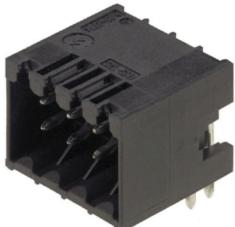
耐高温，直针双层插座，适用于所有常规焊接。为自动装配进行了优化设计。提供盒装或卷带式包装。焊针长度为3.2mm，适合回流焊和波峰焊。该插头提供标记和编码空间。
