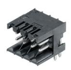
耐高温,直针双层插座,适用于所有常规焊接。为自动装 配进行了优化设计。提供盒装或卷带式包装。焊针长度为 3.2mm, 适合回流焊和波峰焊。该插座提供标记和编码空 间。(按照要求可提供卷带式包装)
