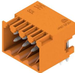
双层弯针插座有标准闭口型或螺钉法兰型（根据要求可提供侧面开口的插座）。焊针长度为 3.5 毫米，适合于波峰焊，提供盒装。可以螺钉连接在线路板上。该插座提供标记和编码空间。
