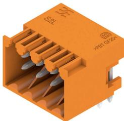
双层弯针插座有标准闭口型或螺钉法兰型 (根据要求可提供侧面开口的插座)。焊针长度为 3.5毫米, 适合于波峰焊, 提供盒装。可以螺钉连接在线路板上。该插座提供标记和编码空间。
