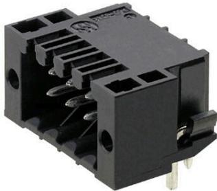
耐高温，直针双层插座，适用于所有常规焊接。为自动装配进行了优化设计。提供盒装或卷带式包装。焊针长度为 3.2mm，适合回流焊和波峰焊。该插头提供标记和编码空间。
