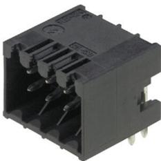
耐高温，直针双层插座，适用于所有常规焊接。为自动装配进行了优化设计。提供盒装或卷带式包装。焊针长度为3.2mm，适合回流焊和波峰焊。该插头提供标记和编码空间。
