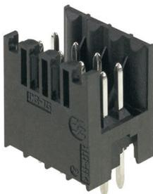
耐高温双层插座，适应所有常见焊接方法。经优化，完美满足自动装配的要求。用纸盒或卷带包装。3.2mm 长的焊针适合采用回流焊和波峰焊进行处理。反向插头上有空间供标记和编码使用。
