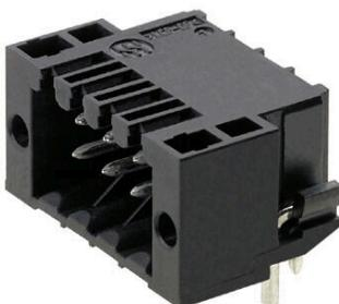
耐高温，直针双层插座，适用于所有常规焊接。为自动装配进行了优化设计。提供盒装或卷带式包装。焊针长度为 3.2mm，适合回流焊和波峰焊。该插头提供标记和编码空间。
