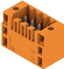
直型双排插座，有闭口或法兰版本（如有要求可提供一侧开放的版本）。插座的插针长为 3.5 mm，适用于波峰焊，盒装。可以螺钉固定于印刷电路板（PCB）。组件上有空间供标记和编码使用。
