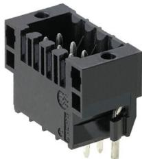
耐高温双层插座, 适应所有常见焊接方法。经优化, 完美满足自动装配的要求。用纸盒或卷带包装。3.2mm 长的焊针适合采用回流焊和波峰焊进行处理。反向插头上有空间供标记和编码使用。
