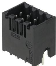
耐高温双层插座, 适应所有常见焊接方法。经优化, 完美满足自动装配的要求。用纸盒或卷带包装。3.2mm 长的焊针适合采用回流焊和波峰焊进行处理。反向插头上有空间供标记和编码使用。
