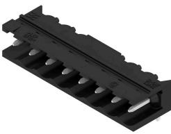
耐高温式插座 (90°) 用纸盒或卷带包装。卷装插座采用 1.5mm 焊针, 适合自动装配。3.2mm 长的焊针适合采用回流焊和波峰焊进行处理。针式插座上有空间进行标记和编码。HC = 大电流
