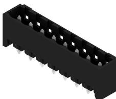
耐高温插座, 采用纸盒包装或卷带包装。卷装插座采用 1.5mm 焊针, 适合自动装配。3.2mm 长的焊针适合采用回流焊和波峰焊进行处理。针式插座上有空间进行标记和编码。HC = 大电流
