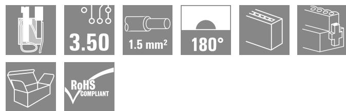
插孔式插头采用直插弹片联接 (PUSH IN) 以及一个插件联接层用于分布式 I/O 电子组件；与 3.50 mm 间距的插针式插座配合使用。
