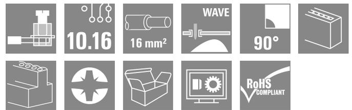
该印刷电路板接线端子可为 76 A、16 mm<sup>2</sup> 导线截面积提供联接，采用久经验证的压线框联接，间距为 10.16 mm，导线出线方向 90°。
