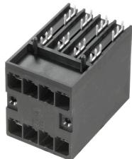
双排大电流、高性能的针式插座, 可带或不带法兰, 免工具实现快速锁定。专为宽 50 mm 及以上“书本大小模块”而改良设计。所集成的安装选项便于将装置固定至外壳壁。100% 防错接轮廓、独特的编码系统和可选的附加螺钉法兰, 保证操作高度可靠、安全。
