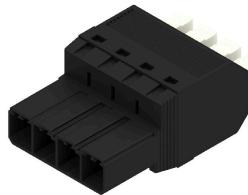
180° 直式反向插座, 带可调执行器 (推送器), 用于现场布线, 规格为 6 mm<sup>2</sup>, 间距为 7.62。也极适合用作针对反向电压的防触电解决方案。符合 UL1059 600 V 等级 C 标准和 IEC 61800-5-1 标准。样式: 无法兰型, 外置法兰型, 卡扣中心法兰型, 还可附加紧固螺钉。
