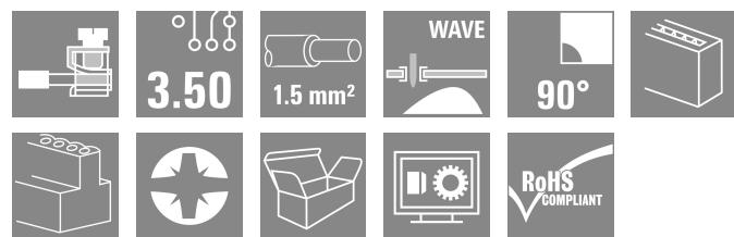
超小型紧凑印刷线路板接线端子，采用片簧联接，间距为 3.5 mm，导线出线方向 90°。适用于最大 1.5 mm<sup>2</sup> 的导线截面积。
