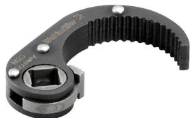
该Screwty®转接器用于定制M23圆形电缆插头和二次成型M23圆形插头的外部规格为 $26.2 \pm 0.3$  mm的滚花螺母。扭紧力矩为 2-2.5 Nm。
