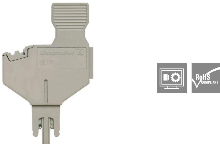
插头组件用于将电气组件安装在可拆式接线端子。电子组件完成焊接之后，可以将插头安装到可拆式接线端子的断开区域，从而将可拆式接线端子变成配有内置电子组件的模块化接线端子。
