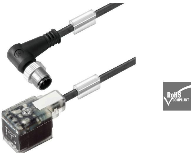
魏德米勒可以提供阀塞作为连接线，其中带有 M8/M12 插头，且单侧开放。阀塞的状态用一个 LED 显示。每个阀塞都有一个保护电路。魏德米勒系列包括符合 DIN 和工业标准的 A、B 和 C 型阀塞。阀塞拧紧后可达到 IP 67 防护等级。出口方向也是一个决定性因素，因此魏德米勒提供不同出口方向的版本。
