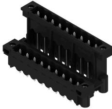
耐高温双层闭合插座, 横向偏置, 可选配焊接法兰。1.5 毫米焊针适合回流焊。3.2 毫米焊针适合回流焊和波峰焊。提供标记和编码空间。
