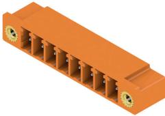
插座 SC 的插接方向平行于印刷线路板（卧式）。可提供闭口型(G)和螺钉法兰型（F）。魏德米勒接插件，间距为 3.81 毫米（0.15 英寸），与标准接插件布局兼容，提供标记和编码空间，支持光导。
