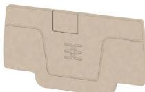
分隔板与端板是接线端子的必要附件。分隔板可实现不同电位和功能组的光学与电气隔离，提升安全性并确保控制柜内部结构清晰明了。端板用于封闭接线端子排的侧面，防止接触带电部件，同时确保整体结构整洁稳固。这两类组件均与魏德米勒相应的接线端子产品系列精确匹配，有助于实现安全、合规且专业的接线。
