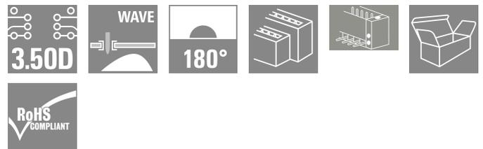
直型双排插座，有闭口或法兰版本 (如有要求可提供一侧开放的版本)。插座的插针长为3.5 mm，适用于波峰焊，盒装。可以螺钉固定于印刷电路板 (PCB)。组件上有空间供标记和编码使用。
