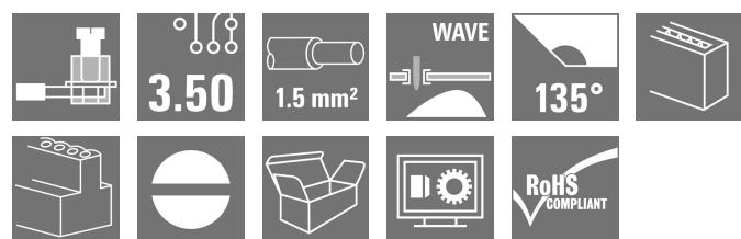
小型紧凑的印刷线路板接线端子，采用久经验证的压线框联接，间距 3.5 mm。导线出线方向 90° 和 135°。适用于最大 1.5 mm<sup>2</sup> 的导线截面积。
