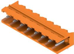
插座由玻璃纤维-增强型聚酯制成，带90°电缆输出；适合波峰焊。法兰版本 (F) 的产品可用螺钉安装到相应的背板或电路板上。使用焊接法兰 (LF) 时，无需在电路板上外加螺钉联接。同时保护焊接点不受机械应力的影响。可以对所有插座进行人工编码或选择订购预编码的插座。HC = 大电流
