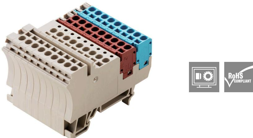
采用模块化设计的 ZIA 配电系统，基于可堆叠的独立模块和成熟的张力弹簧连接技术，实现简便的信号接线。通过集成横向连接以及插座-插针触点的组合，可灵活组装成各种规格的配电条。基础元件可直接卡装在 TS35 DIN 导轨上，并提供适用于三线和四线连接的不同版本。这种设计使系统能够根据特定应用进行个性化配置。
