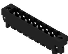
耐高温插座, 采用纸盒包装或卷带包装。卷装插座采用 1.5mm 焊针, 适合自动装配。3.2mm 长的焊针适合采用回流焊和波峰焊进行处理。针式插座上有空间进行标记和编码。HC = 大电流
