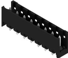
耐高温, 直型开口款插座。用纸盒或卷带包装。卷装插座采用 1.5mm 焊针, 适合自动装配。3.2mm 长的焊针适合采用回流焊和波峰焊进行处理。针式插座上有空间进行标记和编码。HC = 大电流
