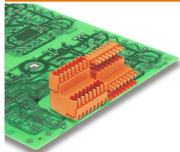
双层交错排针插座，适用于波峰焊，3.50mm 间距。可选用闭口型和法兰型版本。反向插头上有空间供标记和编码使用。
