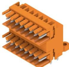
双排针插座，适用于波峰焊，3.50 mm 间距。版本可选择开口型、闭口型或法兰型。反向插头上有空间供标记和编码使用。采用纸板盒包装
