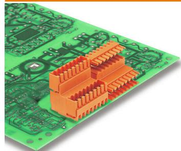
双层交错排针插座, 适用于波峰焊, 3.50mm 间距。可选用闭口型和法兰型版本。反向插头上有空间供标记和编码使用。
