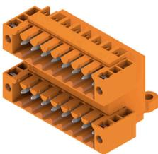
双排针插座，适用于波峰焊，3.50 mm 间距。版本可选择开口型、闭口型或法兰型。反向插头上有空间供标记和编码使用。采用纸板盒包装
