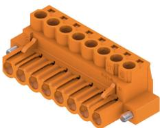
压线框接线插头, 用于直式 (180°) 电线联接。插头上有空间供标记和编码使用。通过法兰或释放杆锁紧。提供十/一字头螺钉和导线误插保护, 供货时压线框打开。HC = 大电流
